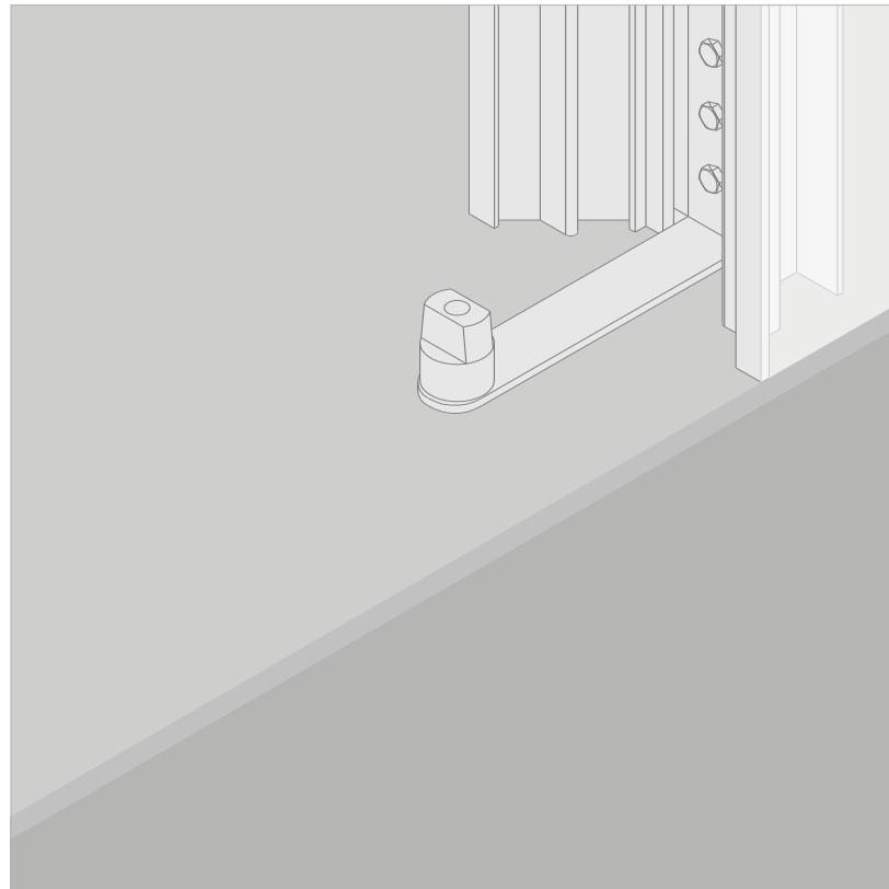
La versione con perno di rotazione su staffa laterale permette di installare il falso telaio anche a pavimento finito. Il perno di rotazione è alloggiato su una staffa in acciaio che può essere fissata indifferentemente sul lato destro o sinistro e viene nascosta dalla porta, una volta montata. Questa soluzione non è disponibile per le porte su misura 1200 x 2600.
