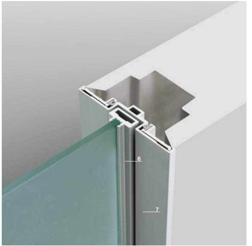
6 Telaio in estruso d'alluminio (lega EN AW-6060 stato fisico T6). Ossidazione anodica conforme alle norme UNI EN 12373, UNI EN ISO 9227, ISO 2370, BS 6161
