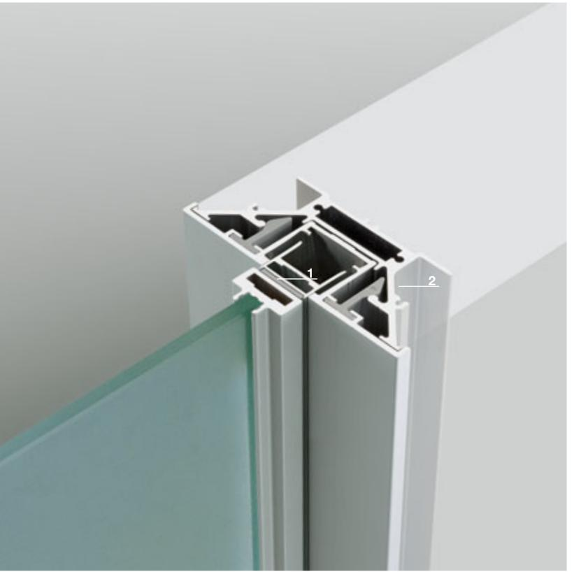
1 Profilo di battuta in gomma siliconica, con sistema di chiusura magnetica a scomparsa brevettato
