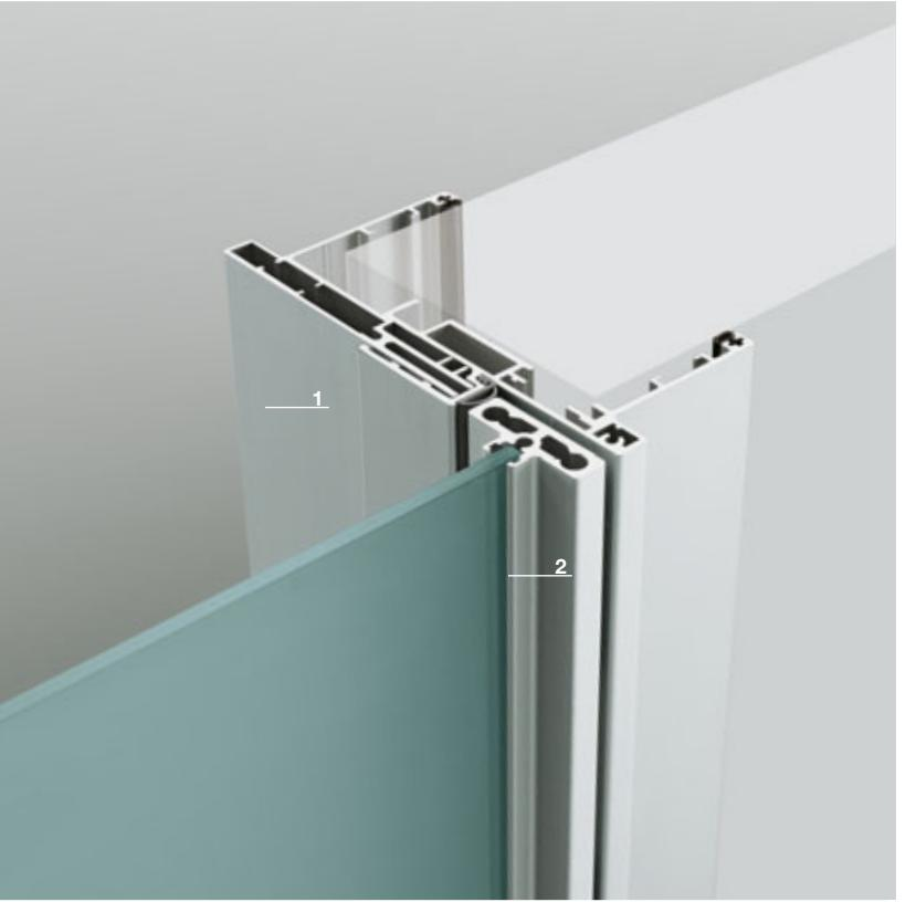
1 Stipite telescopico per porta battente in estruso d'alluminio (lega EN AW-6060 stato fisico T6). Disponibile in quattro versioni, per un'estensione complessiva compresa fra 75 e 270 mm. Ossidazione anodica conforme alle norme UNI EN 12373, UNI EN ISO 9227, ISO 2370, BS 6161
