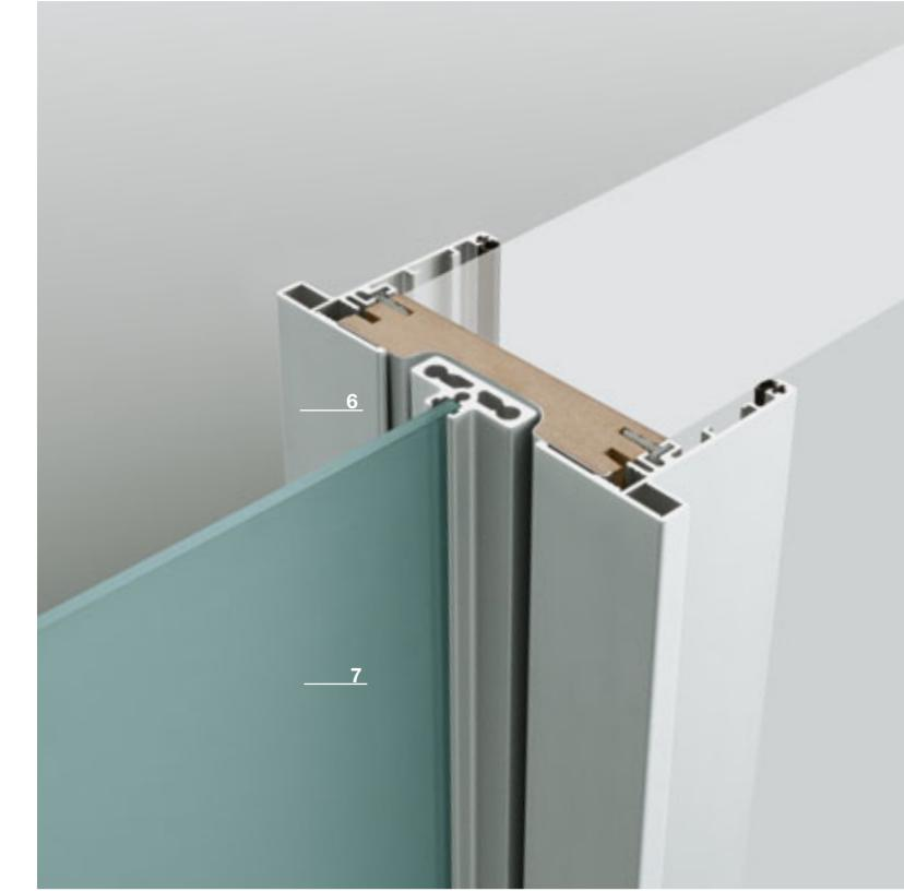
6 Stipite telescopico per porta scorrevole a scomparsa in estruso d'alluminio (lega EN AW-6060 stato fisico T6). Estensione complessiva compresa fra 107 e 147 mm. Ossidazione anodica conforme alle norme UNI EN 12373, UNI EN ISO 9227, ISO 2370, BS 6161
