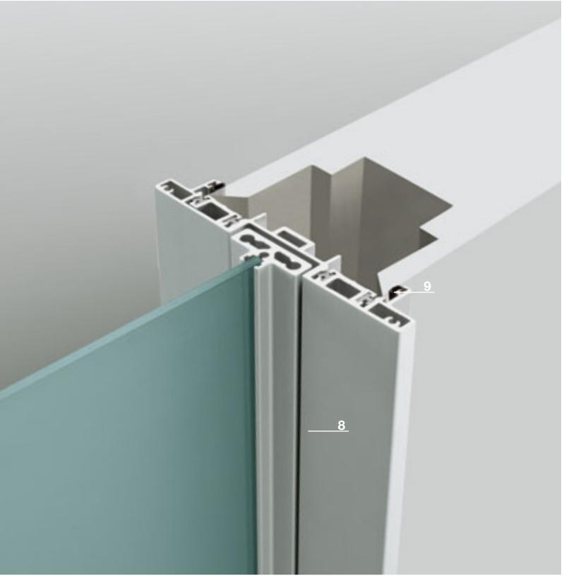
8 Stipite ultrasottili con montaggio ad incastro senza viti e giunzioni a vista, per controtelai a scomparsa Scrigno® mod. Essential e Eclipse mod. Syntesis. Estruso d'alluminio (lega EN AW-6060 stato fisico T6). Ossidazione anodica conforme alle norme UNI EN 12373, UNI EN ISO 9227, ISO 2370, BS 6161
